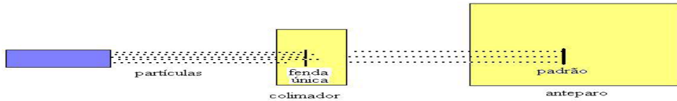
Figura 01: as partículas são colimadas por uma fenda e incidem no anteparo formando um padrão de interferência com uma franja apenas.
