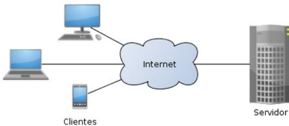
No modelo cliente-servidor, um processo cliente em uma máquina se comunica com um processo servidor na outra máquina.
