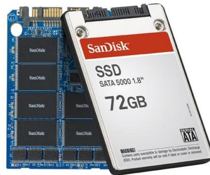
O SSD (solid-state drive) é uma nova tecnologia de armazenamento considerada a evolução do disco rígido (HD). Ele não possui partes móveis e é construído em torno de um circuito integrado semicondutor, o qual é responsável pelo armazenamento, diferentemente dos sistemas magnéticos (como os HDs).
