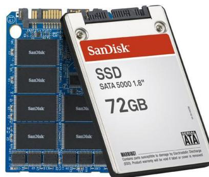
O SSD (solid-state drive) é uma nova tecnologia de armazenamento considerada a evolução do disco rígido (HD). Ele não possui partes móveis e é construído em torno de um circuito integrado semicondutor, o qual é responsável pelo armazenamento, diferentemente dos sistemas magnéticos (como os HDs).
